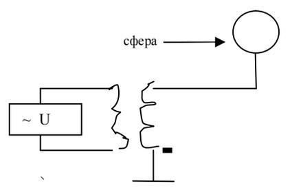
Моделью частицы имеющий переменный электрический заряд является сфера, на которую подается переменное напряжение. **Ожидаем, что сфера переменного заряда является источником скалярного магнитного поля.**
